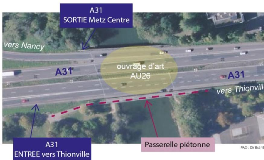
Les inspections détaillées de l'ouvrage ont révélé des soucis d'étanchéité conduisant à un début d'endommagement des bétons. La première partie de la réparation a eu lieu en 2021 sur le dessus du tablier, avec une reprise de l'étanchéité, des enrobés et des dispositifs de sécurité.
