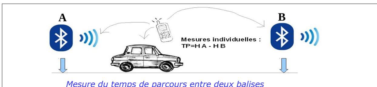
Lorsqu'un véhicule disposant d'un équipement connecté en Bluetooth est détecté au point A (balise 1) l'heure de son passage est enregistrée. Elle est également enregistrée lorsque ce même véhicule passe au point B (balise 2).
